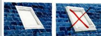
Pour une bonne intégration dans la toiture, les fenêtres de toit doivent se trouver au nu de l'ardoise.
