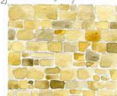
2) appareillage en moellons avec joints réguliers
