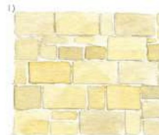
appareillage en pierre de taille assez régulier
