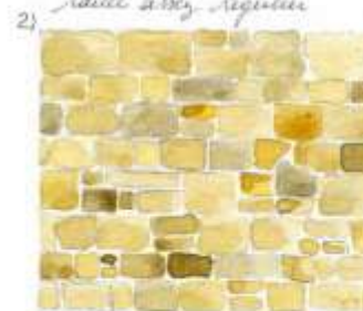
appareillage en moellons assez régulier
