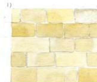
appareillage en pierre de taille régulier
