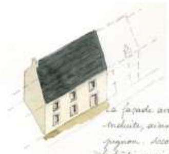
L'encadrement de la fenêtre est en saillie par rapport au reste du mur. Celui-ci était donc destiné à être enduit.
