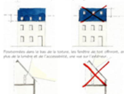
De même que les ouvertures en façade sont verticales, les fenêtres de toit seront plus hautes que larges.
