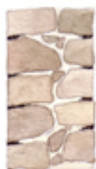
Joints fins affleurant le parement
