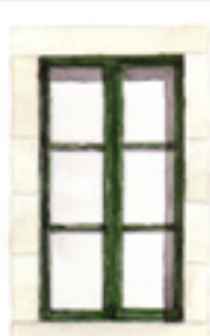
Fenêtre à 2 vantaux, 6 carreaux, en alu peint.
