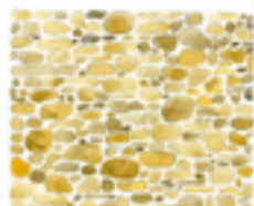
appareillage de moellons équarris et non équarris, de taille irrégulière et non assisés.
